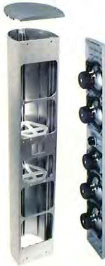
*I trasduttori sono installati su una piastra rigida in alluminio pressofuso inserita in una cassa in alluminio estruso a struttura molto rigida che permette di ridurre ancor di più le risonanze indesiderate.*
